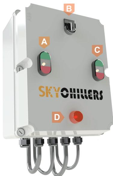
**A.** Botonera para bomba de recirculación **B.** Selector operación: manual / apagado / automático **C.** Botonera para bomba de proceso **D.** Indicador de falta de agua en el tanque
